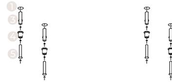
Infilare nel foro **1** il tassello **3** poi la boccola filettata **4** e poi la vite **5** per bloccare il tutto. (ripetere per ogni cavo)
