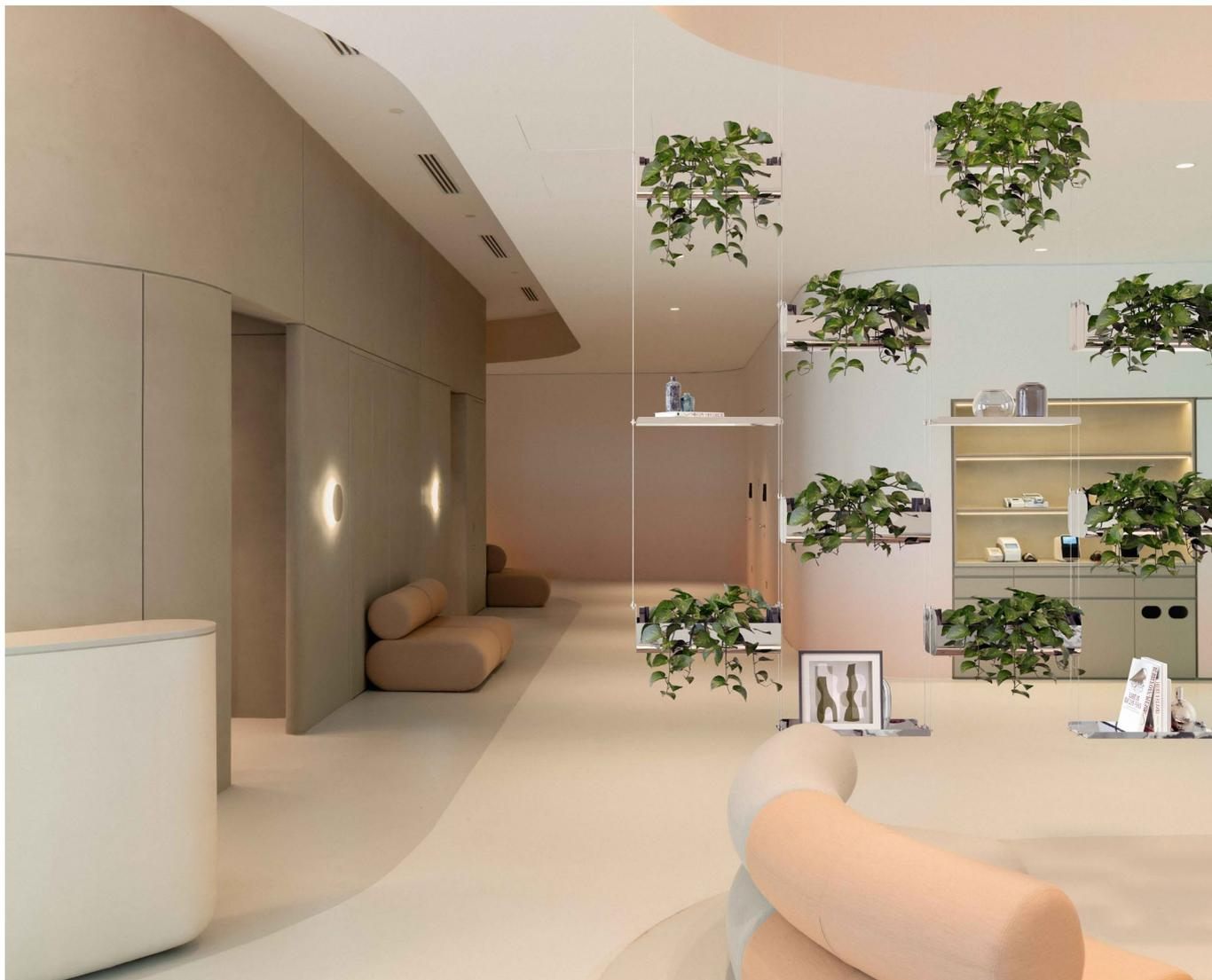
Con Fall si è voluto sfruttare gli elementi a vaschetta per il verde verticale, tipici di VerdeProfilo. Questi stessi elementi sono stati modificati e racchiusi in una scocca, in modo da poter sfruttare la crescita di piante da due lati, dei tiranti metallici tengono uniti i moduli in modo alternato creando un gioco di movimento, pieni e vuoti.
