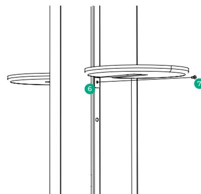
Allineare il foro del supporto a L del tavolino con quello sulla struttura 6 e fissare il tutto con la vite 7.
