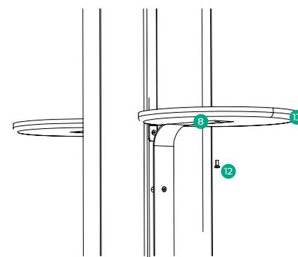
Avvitare la seconda vite di blocco 12 del tavolino in legno 13 con il supporto a L e supporto del piano 8.
