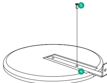
Allineare il foro 4 del supporto a L con quello del tavolino e avvitare solo una vite 5.
