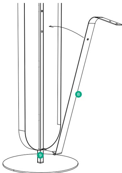
Posizionare il supporto 8 del piano in legno incastrando prima la base del supporto 8 al tubolare 9 e poi ruotandolo.
