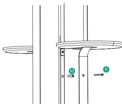
Posizionare il distanziale 10 tra supporto 8 e struttura 9 ed infine avvitare la vite di blocco 11.
