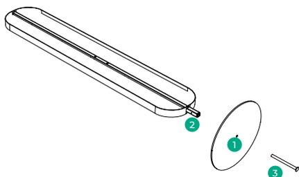
Allineare il foro 1 della base circolare con quello della struttura 2 e fissare la vite 3.
