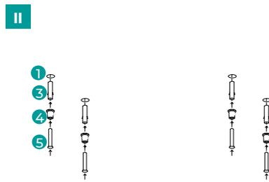
Infilare nel foro **1** il tassello **3** poi la boccola filettata **4** e poi la vite **5** per bloccare il tutto. (ripetere per ogni cavo)
