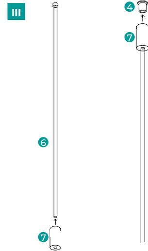
Infilare il cavo **6** nella cover della boccola **7** e poi avvitare la cover **7** sulla boccola filettata **4**. (ripetere per ogni cavo)
