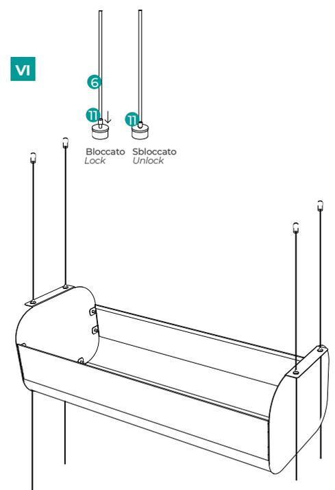
Regolare il cavo **6** tirando verso il basso il blocco **11** sull'inserto col blocco cavo **8**. (ripetere per ogni cavo)
