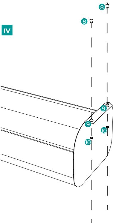
Posizionare gli inserti filettati col blocco cavo **8** all'interno dei fori **9** presenti sul FALL e avvitare poi il dado di bloccaggio **10**. (ripetere per ogni cavo)
