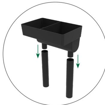
Il sistema di irrigazione è composto da un imbuto graduato inserito in due tubi pre-assemblati all'interno delle vaschette.
